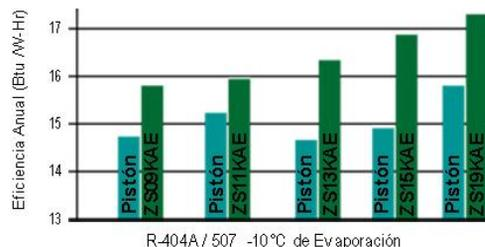
Valores Nominales de Capacidad @ 60Hz con R404A / R507; a  $-7^{\circ}\text{C}/49^{\circ}\text{C}$  y  $18,3^{\circ}\text{C}$  de Gas de Retorno; 0 K de Subenfriamiento.
